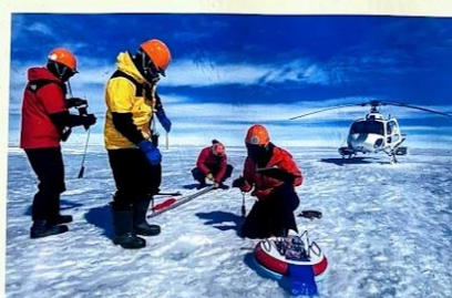
一般研究観測:「うねり」による定着氷崩壊メカニズム解明に向け、氷上に波浪ブイを設置しました。
