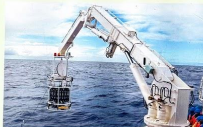
定常/海洋物理・化学観測:CTD採水システム等により南極底層水の観測を実施しました。
